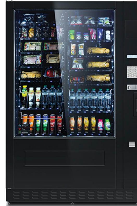
luce XL6 multishop Teclado capacitivo de 24 botones Pantalla 16x2 Capacidad hasta 1680 productos hasta 14 estantes x máx. 6 espirales cada unidad frigorífica R290 FTCA - LED Flexspir opcional
